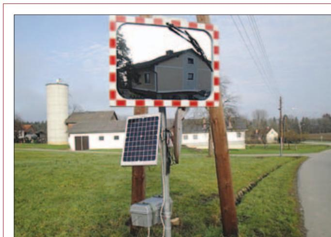
**VERKEHRSSPIEGEL.** In der Ortschaft Ponigl gibt es einen modernen Verkehrsspiegel. Er ist mit einem Scheibenwischer versehen. Mittels Sonnenenergie wird eine Batterie gespeist und der Scheibenwischer, wenn der Spiegel angefahren ist, mittels Fernbedienung betätigt. Diese Eigenkonstruktion ist das Werk von Ing. Ferdinand Knäfl.
