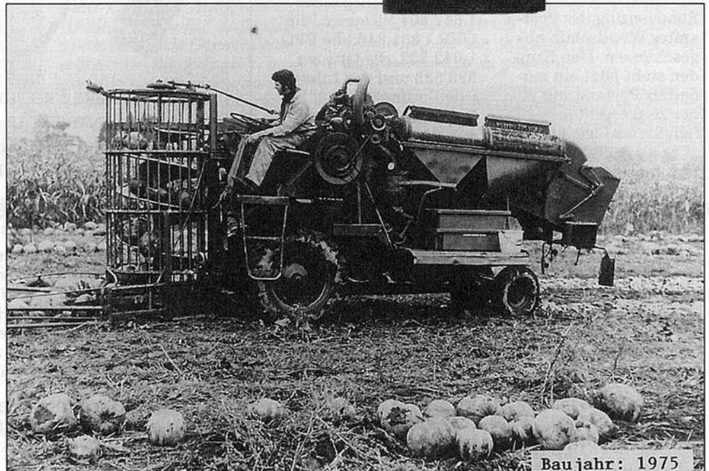
Die erste patentierte, vollautomatisch selbstfahrende Kürbiserntemaschine von Anton Liebmann, Baujahr 1975. Als Grundgerüst diente ein Bautz-Mähdrescher.
